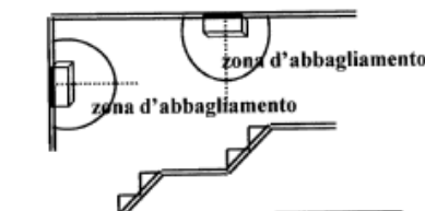
Figura 4.12: zona di abbagliamento per vie di fuga non orizzontali
