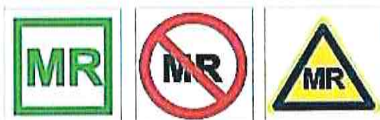
Figura 2: da sinistra: etichette safe (verde), unsafe (rossa) e conditional (gialla). Per i primi non sussiste nessun divieto. Gli oggetti etichettati “MR-Unsafe” non possono essere introdotti in sala magnete in nessun caso. Gli oggetti classificati “conditional” possono essere introdotti all’interno della sala magnete, rispettando restrizioni specifiche.
